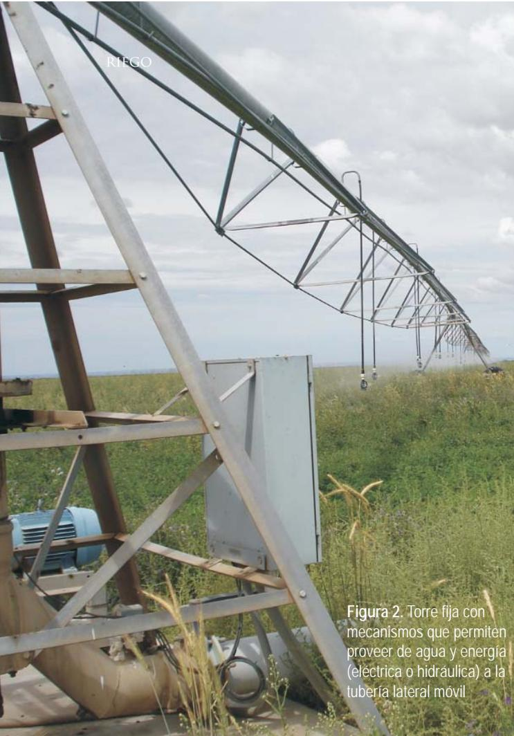
Figura 2. Torre fija con mecanismos que permiten proveer de agua y energía (eléctrica o hidráulica) a la tubería lateral móvil
