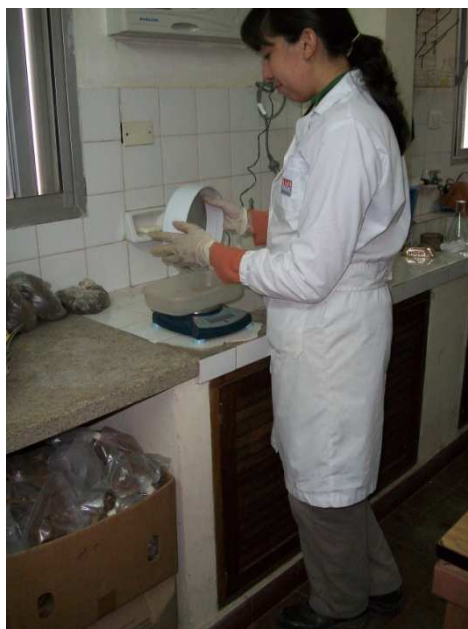
Figura 4. Pesaje de las muestras en el análisis granulométrico
