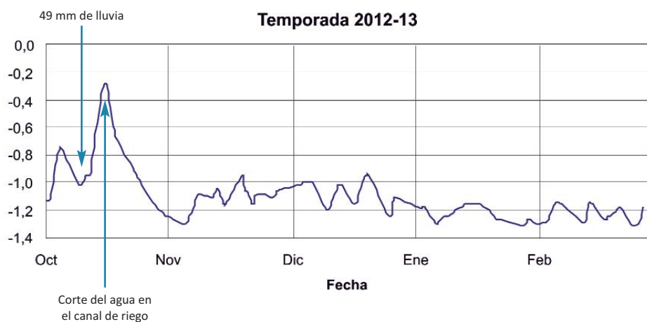
Figura 7. Ubicación de la capa freática en un monte de peral durante la temporada 2012-2013. Estación Experimental INTA Alto Valle
