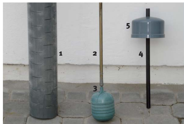
Figura 1. Componentes del freatómetro de lectura directa: (1) Caño ranurado de 110 mm (2 m), (2) Varilla metálica de 12 mm de 2 m, (3) Flotador, (4) tubo de PVC de 16 mm, (5) tapa de PVC 110 mm
