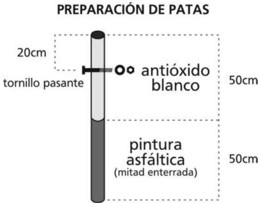
Figura 4: Preparación de las patas del túnel alto.
