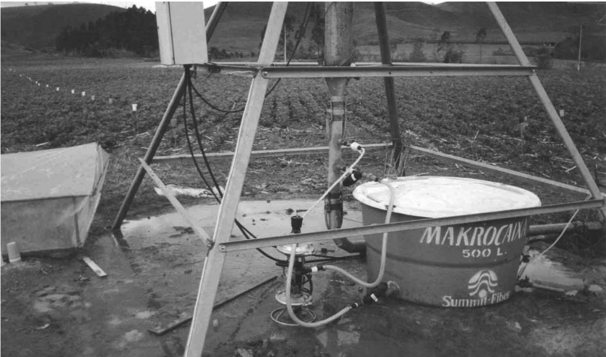
Figura 12.3. Detalle de una bomba de diafragma utilizada para inyección de agroquímicos junto a un pivot central
