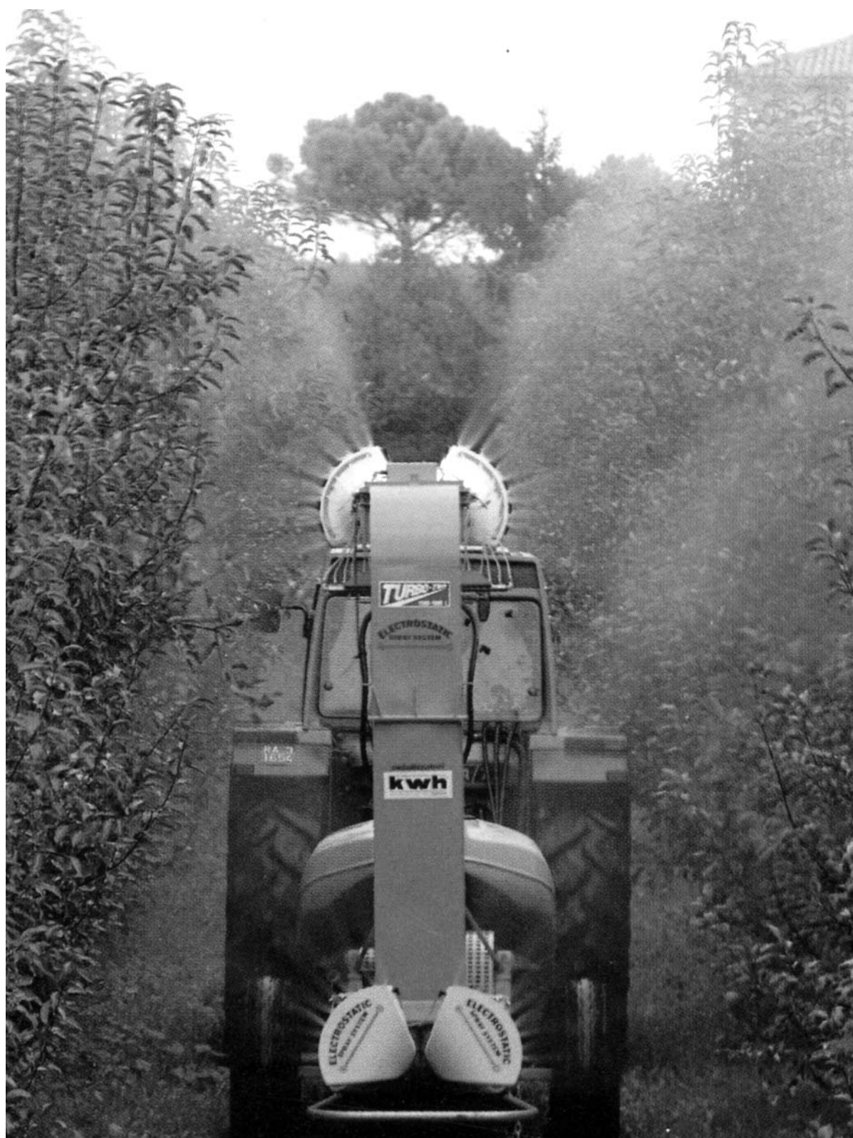
Figura 8.2. Equipo pulverizador neumático-electroestático para cultivos frutales (Fuente: Martignani, 1983)
