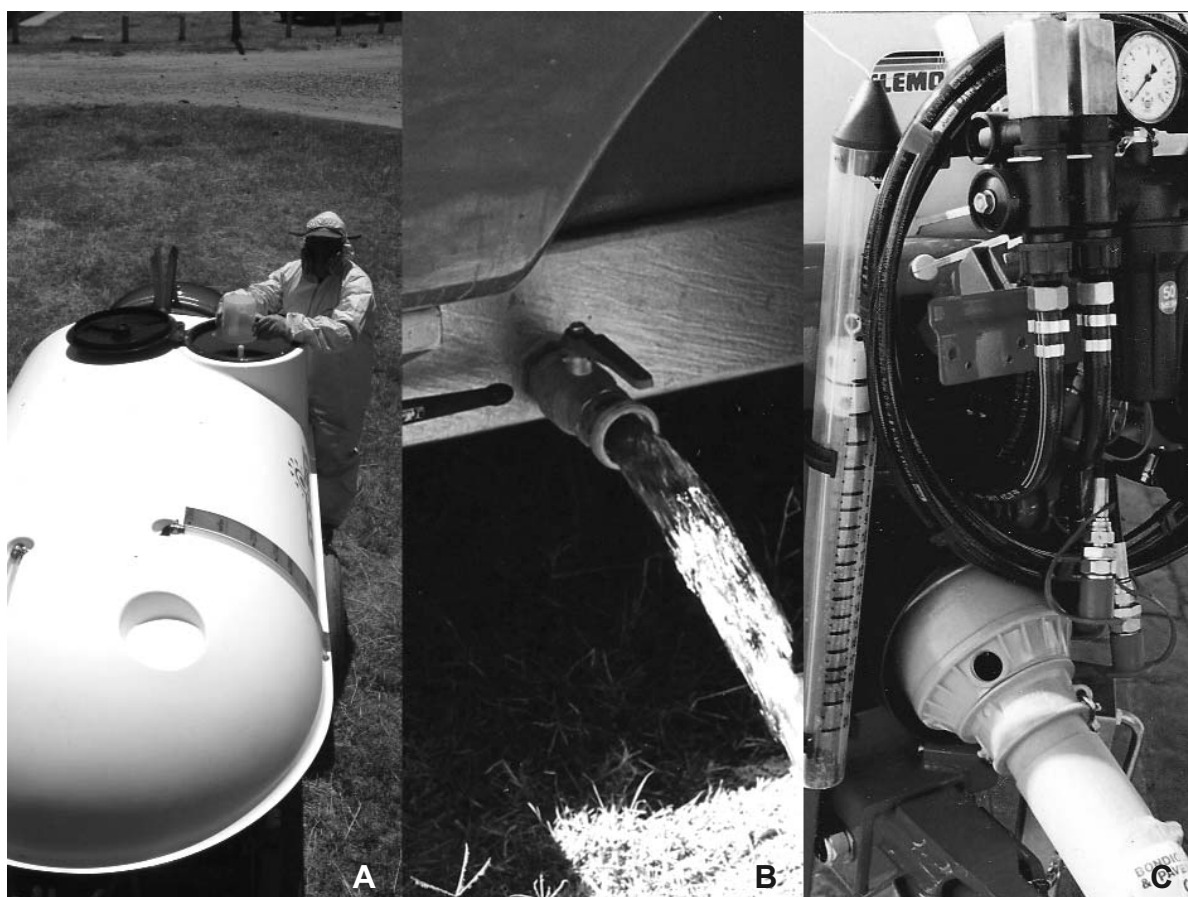
Figura 9.2: A) Boca del tanque amplia y accesible; B) Válvula de drenaje accesible; C) Escala indicadora de nivel.
