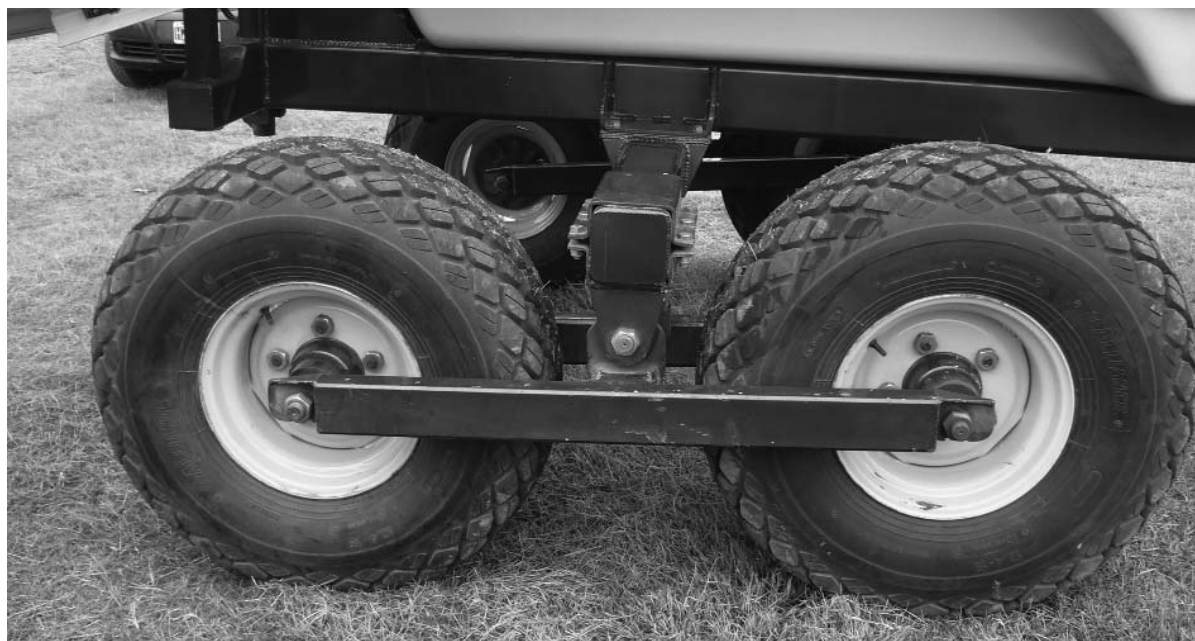
Figura 9.13. Equipo pulverizador con ruedas en tanden con balancines
