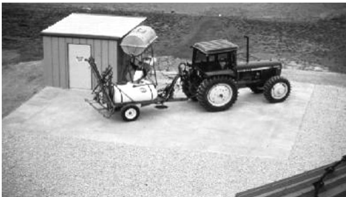
Figura 14.1. Centro de cargas de equipos pulverizadores
