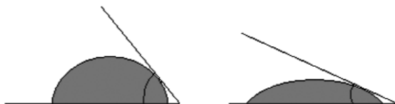
Figura 2.1. Ángulo de contacto de la gota con la hoja
