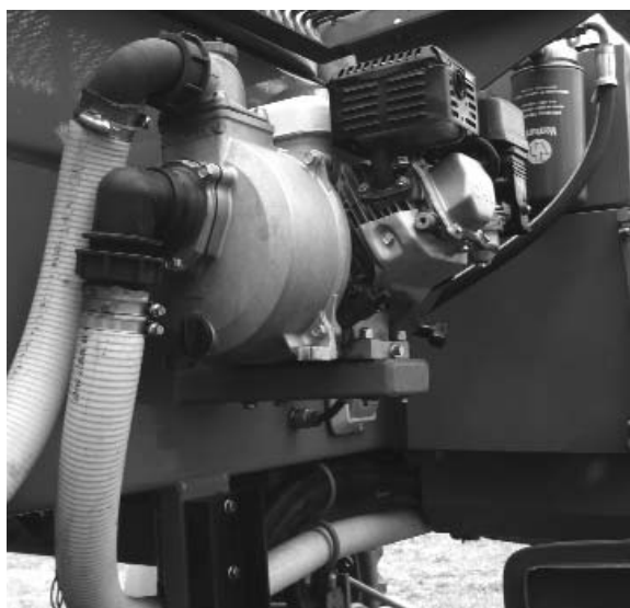
Figura 9.3. El uso de bombas de gran caudal para el llenado del tanque aumentan la capacidad de trabajo
