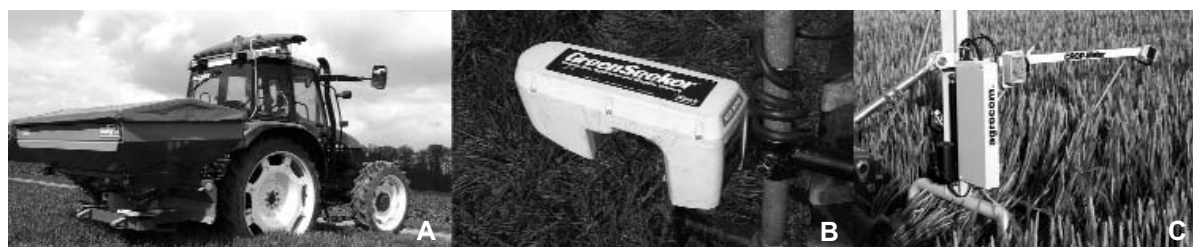
Figura 15.4. Sistemas para la dosificación variable proporcional en tiempo real: A) Yara N-Sensor montado encima de la cabina del tractor; B) GreenSeeker montado sobre una plataforma terrestre; C) Crop-Meter montado en la parte delantera del tractor (Fuente: Yara, 2010; del autor; Agrom, 2010)
