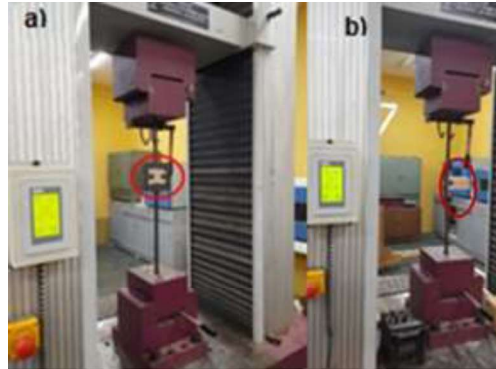
Figura 1. Ensayo en máquina universal. a) tracción perpendicular a las fibras. b) clivaje o rajadura perpendicular a las fibras.
