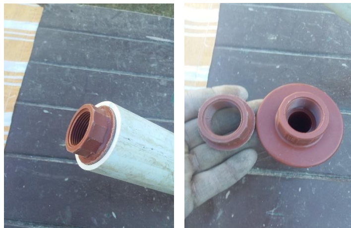
Figuras 11 y 12. Prueba de unión de tanque cortada e introducida en el caño de PVC de 50 mm
