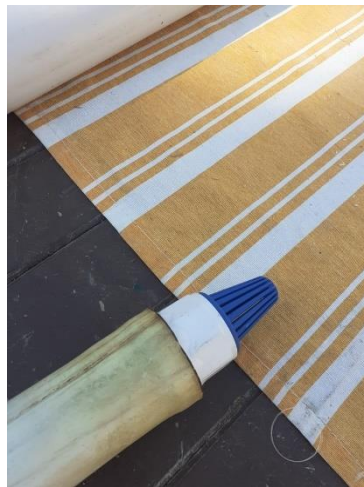
Figura 2. Caño de PVC cortado y válvula pegada a uno de sus extremos. Esta parte es la que estará en contacto/sumergida en el agua.
