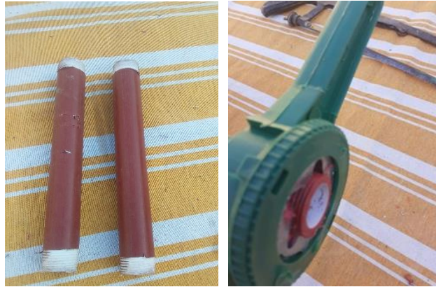
Figura 19. Armado de niples de 10 cm.
