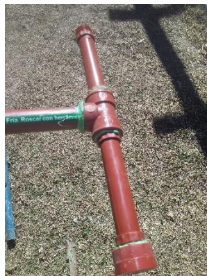
Figura 20. Ensamble del mango con los niples y el caño de polipropileno de 1,8 m.
