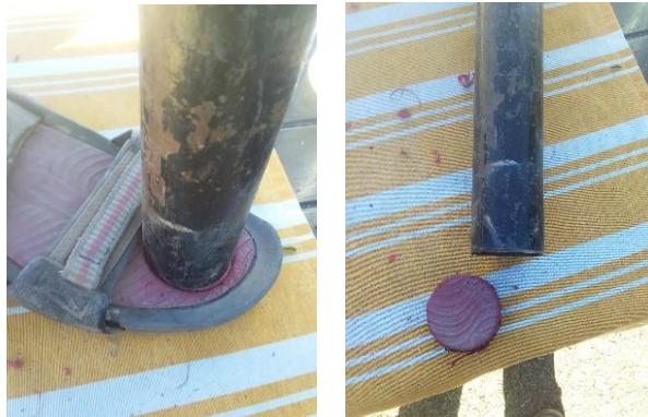
Figura 13 y 14. Corte de la ojota con caño metálico para obtener el círculo de goma.
