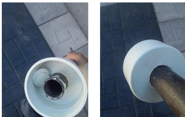
Figura 3 y 4. Tapa de PVC agujereada con la ayuda de un hierro caliente.
