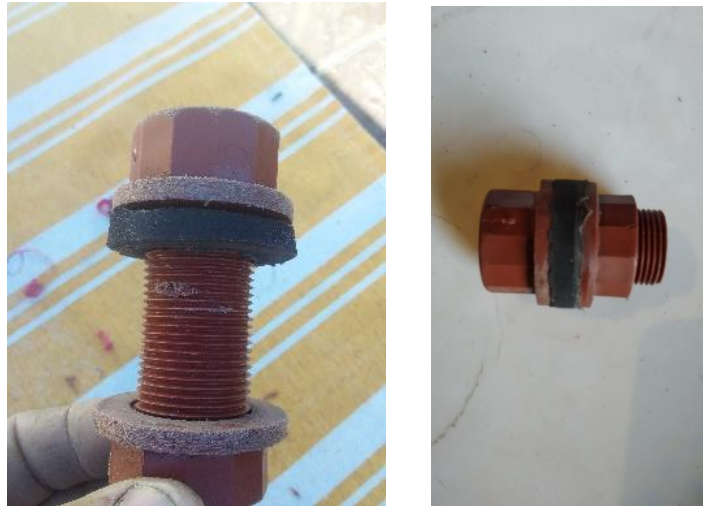
Figura 16 y 17. Ensamble de la unión de tanque y la arandela de goma.
