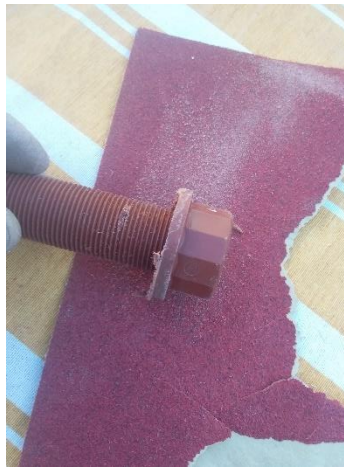
Figura 10. Lijado de la unión de tanque con lija N° 120. Corrección de imperfeciones para garantizar el ajuste.
