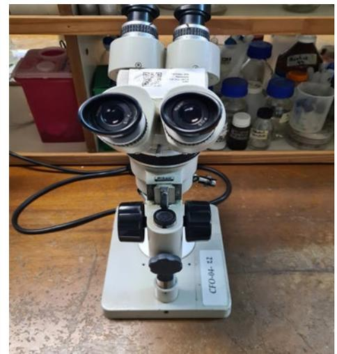
→ Lupa estereoscópica binocular
