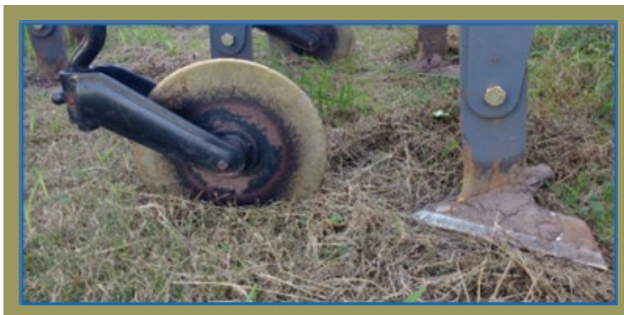
Figura 2a: Vista lateral del timón con la reja plana y cuchilla corta rastrojo
