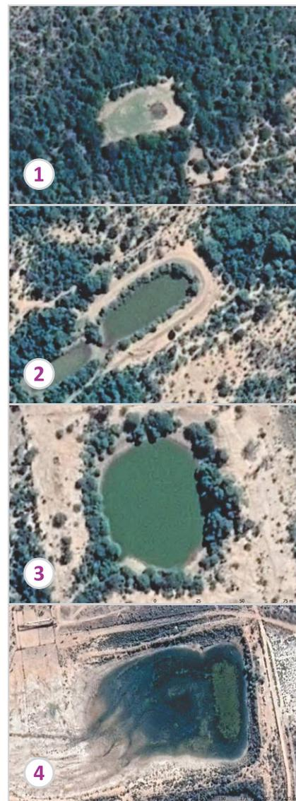
Figura 5. 1) Represa de tamaño mínimo identificada (200 m<sup>2</sup>), denomina en la zona “pozo de verano”. 2) Represa modal (900 m<sup>2</sup>). 3) Represa de tamaño promedio (3400 m<sup>2</sup>). 4) Represa de tamaño máximo (<10000 m<sup>2</sup>).
