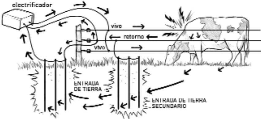
En zonas semiáridas y áridas es muy difícil definir la profundidad hasta donde habrá que enterrar la toma de tierra, ya que depende de diversos factores, como el tipo de suelo, el régimen de lluvias, profundidad de las napas y la extensión del sistema que se pretenda armar.
