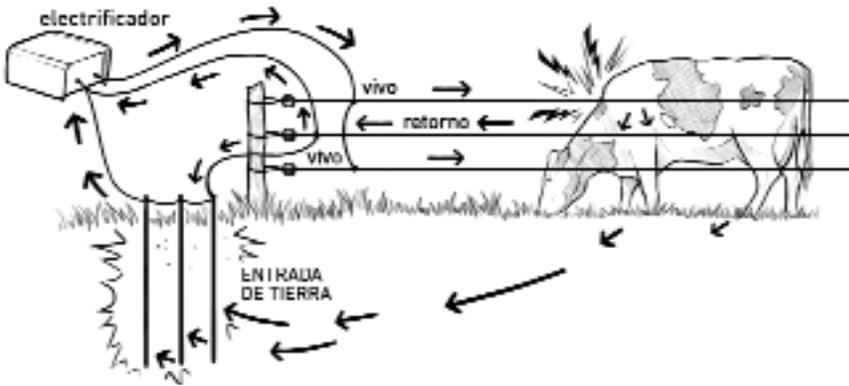
El alambre o cable de cobre no es adecuado para hacer interconexiones con el equipo y el alambre galvanizado, porque forma óxido y este disminuye la conductividad eléctrica.
