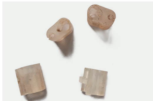
D. Pinza en forma de tubo para unión de pie y copa.
