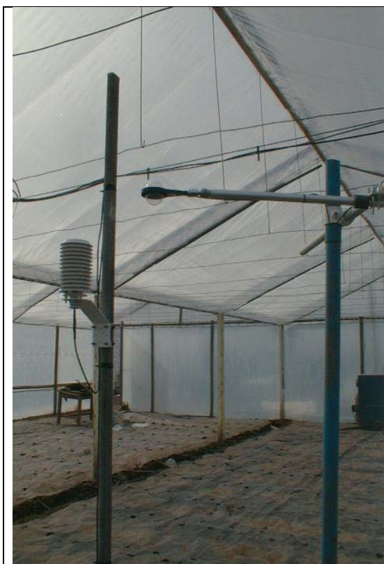
Figura 1.2.2. Sensores de temperatura, humedad y radiación neta en el invernadero
