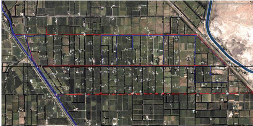
Figura 1: Red de Puntos de Observación – Canales (--) - Desagües (--)
