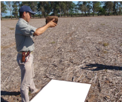
Figuras 6a y 6b ( debajo y derecha ) Muestra de suelo que se deja caer para realizar el test de estallido.
