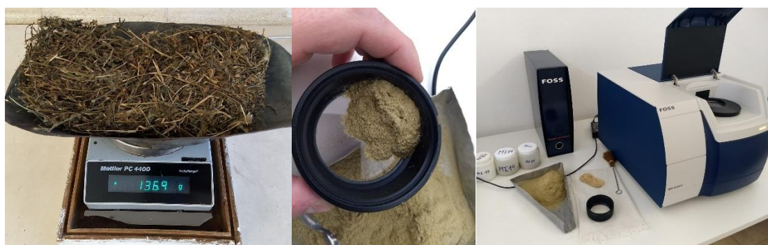
Figura 7: Determinación de calidad de cada muestra en NIRS Foss 2500, luego de realizado Materia Seca y molido con malla de 0,5 mm.
