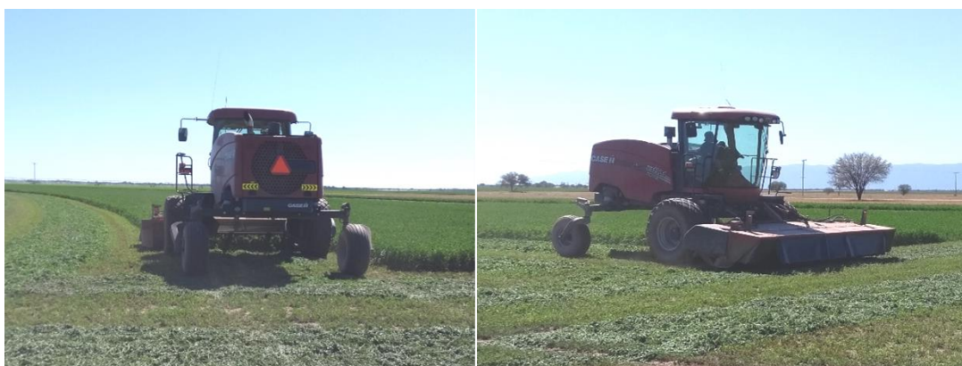
Figura 4: Segadora a discos Case WD 1904 con cabezal de 4,71 m de ancho de corte.
