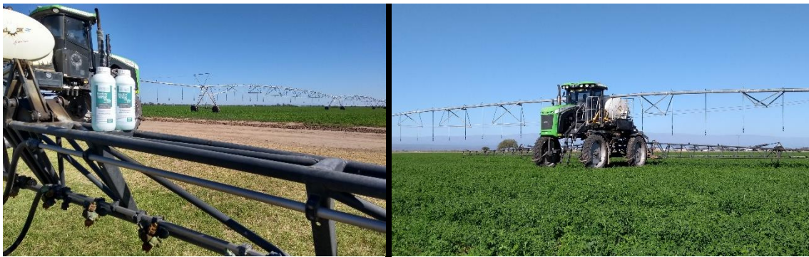
Figura 2: Pulverizadora Metalfor 7040 con botalón de 24 m ancho utilizada en el ensayo.
