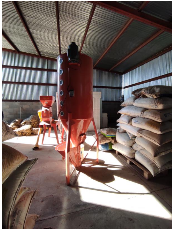
Máquina molidora Loyto N°5 con toma de fuerza al tractor.
