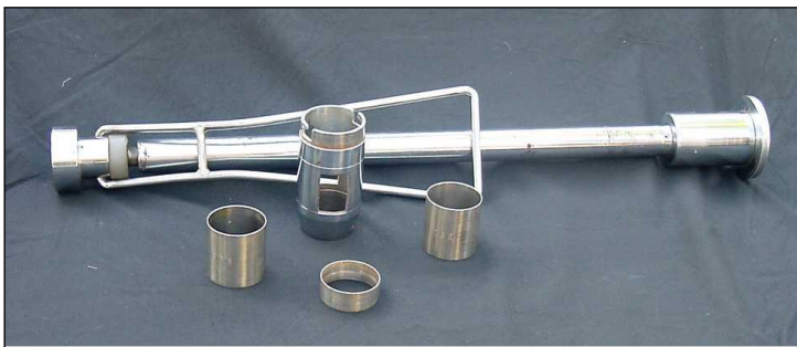
Figura II.2: Muestreador y cilindros para la determinación de las curvas de retención de humedad.
