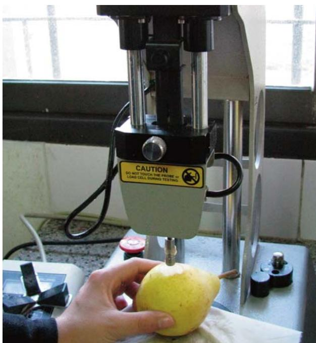
Foto 2. Determinación de firmeza mediante penetrómetro.
