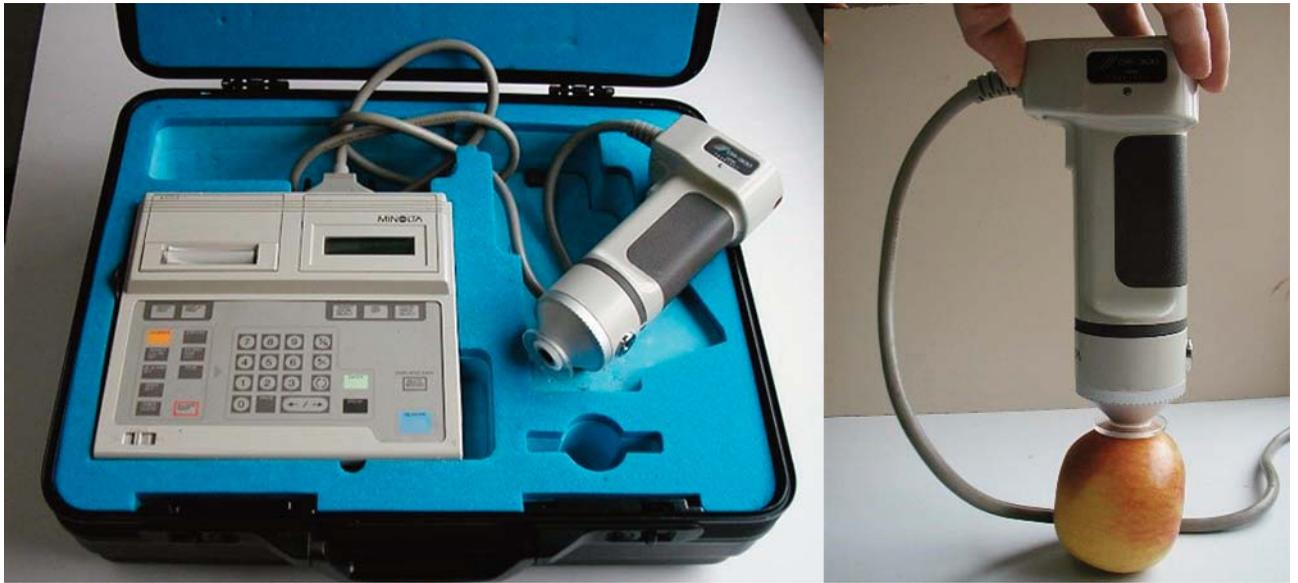
Foto 6. Medición del color mediante colorímetro.
