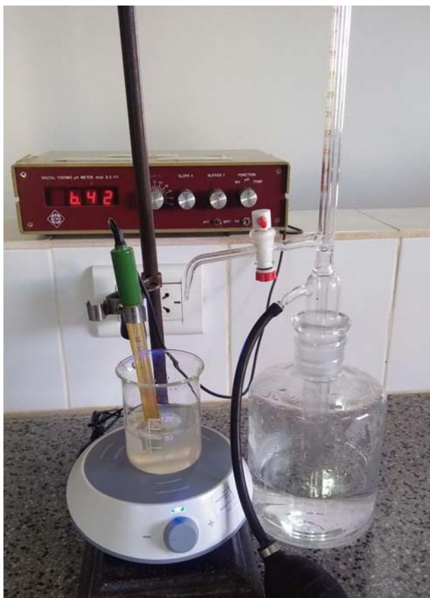
Foto 3. Determinación de acidez mediante titulación.
