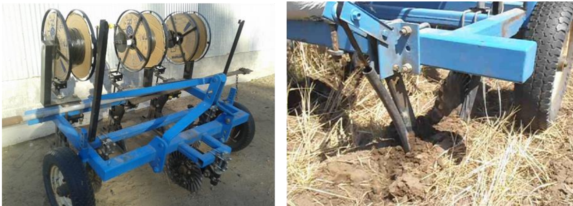
Figura 1. Izq. Vista del implemento enterrador de tubería utilizado. Der. Detalle de la labor de corte de cobertura y enterrado de lateral de goteo.
