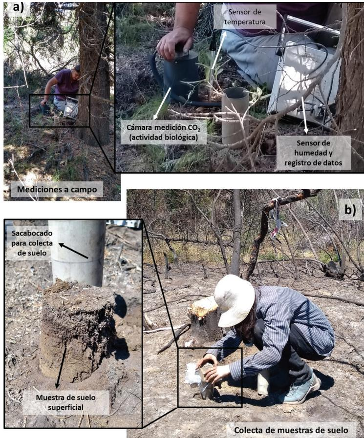
Figura 3: a) Medición a campo de temperatura, humedad y actividad biológica del suelo, b) colecta de muestras de suelo para determinaciones de pH y CE en laboratorio.
