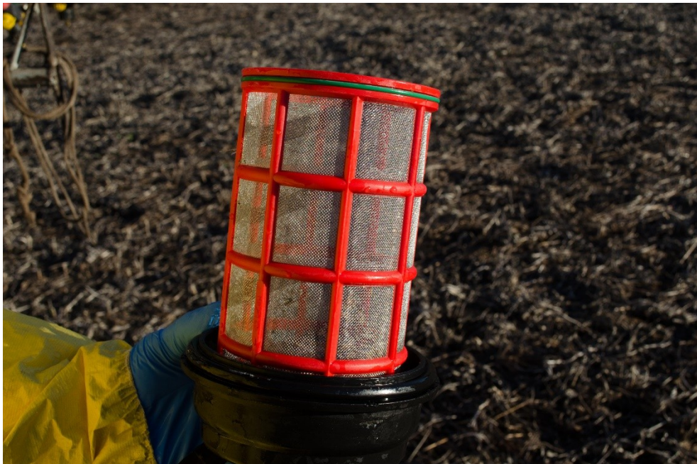
Figura 5. Filtro principal de aspiración en buen estado
