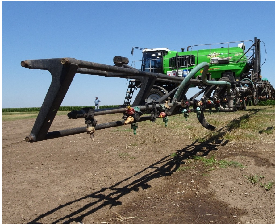
Figura 6. Botalón estabilizado y con altura adecuada en todo su recorrido
