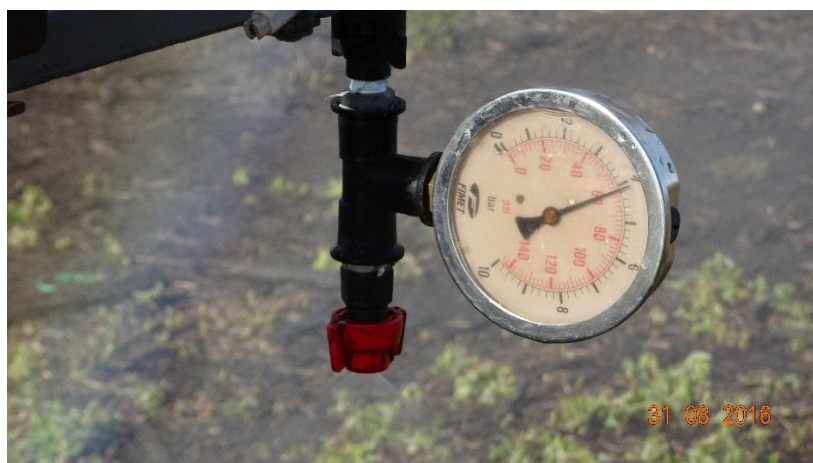
Figura 7. Manómetro calibrado para control de presión en la barra
