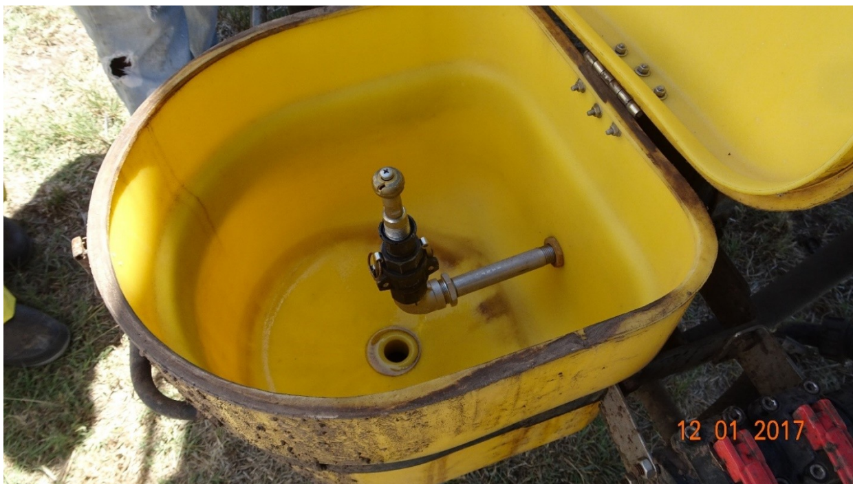
Figura 4. Incorporador de producto básico con sistema de enjuague de envases y sin rejilla en el fondo (zona de succión)
