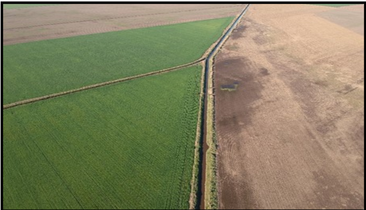
Fotografía 11. Canal para lograr mitigar el impacto de los excedentes hídricos sobre los caminos de la cuenca Garione (Consortio Canalero Marcos Juárez Gral. Roca)
