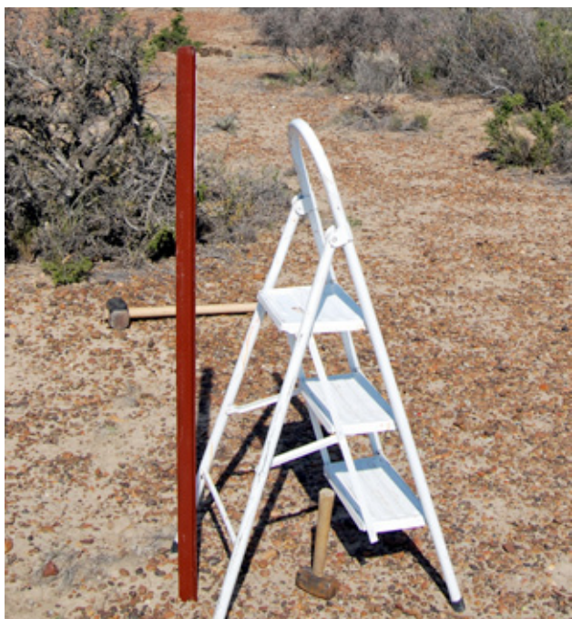
Foto 12: La fotografía se toma desde unos 2.5 m de altura usando la caja de la camioneta o una escalera.
