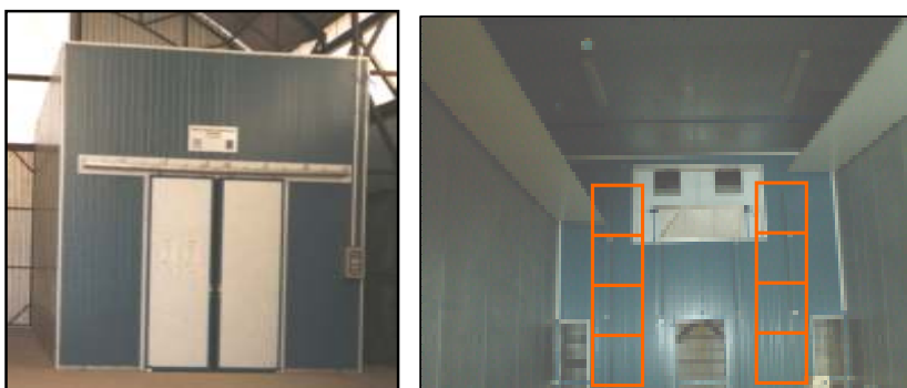
Figura 15 - Tunel de secado tipo "californiano" – Izquierda vista externa. Derecha vista interna
