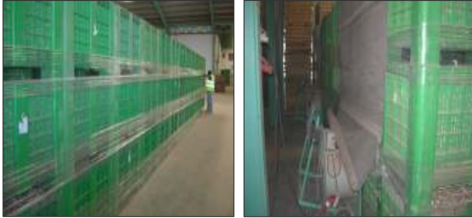
Figura 21 - Armado de túneles de secado por succión. Izquierda, "imperabilización" exterior de bins con film plástico. Derecha, extractores.
