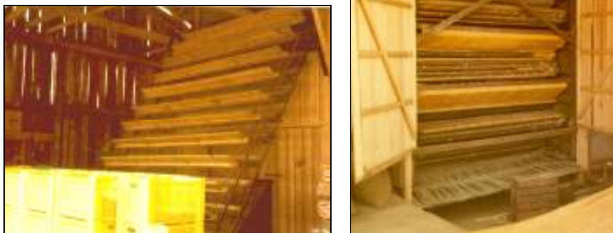
Figura 14 - Vista de zona de carga superior y descarga inferior de túnel de secado de cinta continua.
