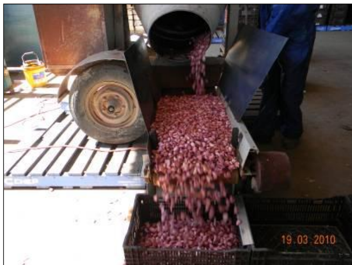
Figura 1 - Hormigonera adaptada a la desinfección de semilla por el método de "embarrado"
