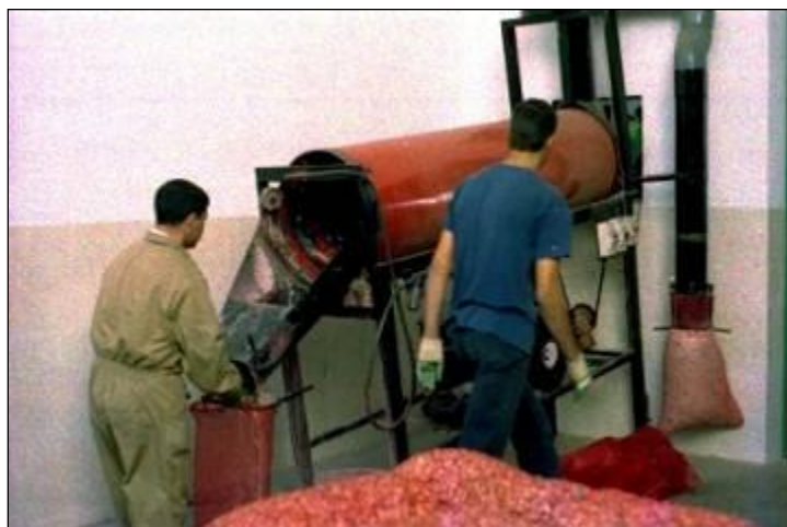
Figura 3 - Cilindro continuo de accionamiento eléctrico para tratamiento de diente-semilla
