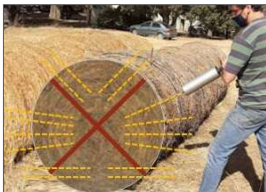
Figura 8: Cada muestra compuesta enviada a laboratorio para determinación de calidad final (una por repetición) se conformó de 16 submuestras tomándose 4 por cuarto de rollo para representar lo más fielmente posible la calidad evaluada.
