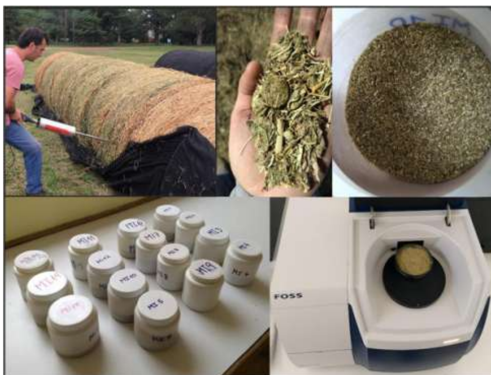
Figura 9: Obtención de muestras compuestas y envío a laboratorio para determinación de calidad mediante NIRS FOSS DS-2500.
