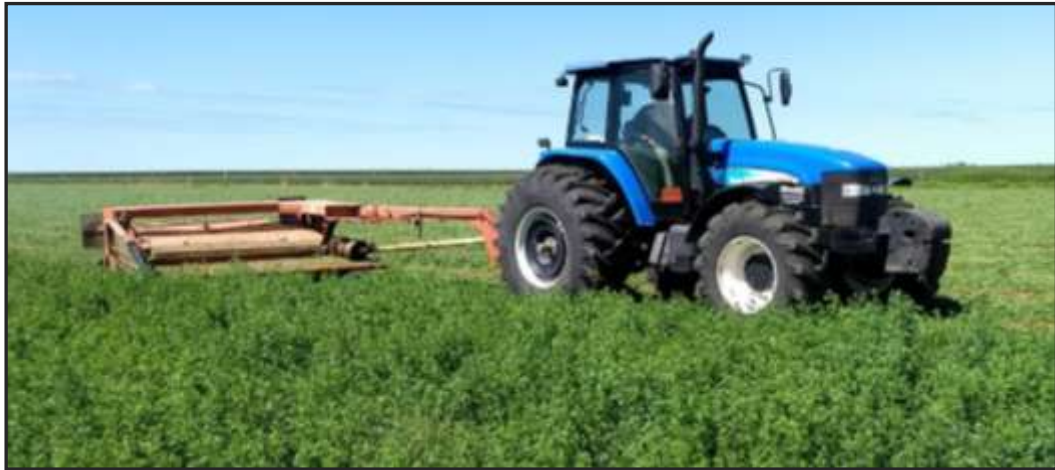
Figura 2: Corte con segadora acondicionadora Kuhn FC 300 R, en estado fenológico de la alfalfa, entre botón floral y 10% de floración.
