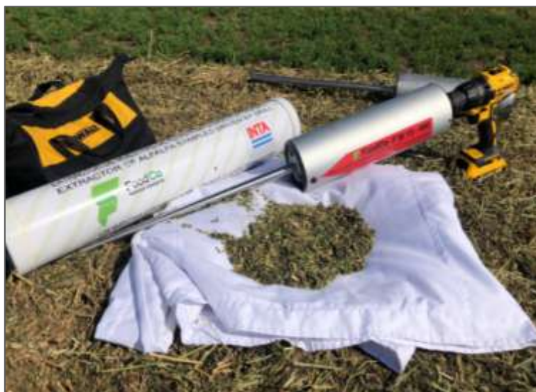
Figura 7: Muestreador de sonda modelo FoodCo - INTA FM 13-450 utilizado para la obtención de la muestra compuesta inicial de todo el heno.
