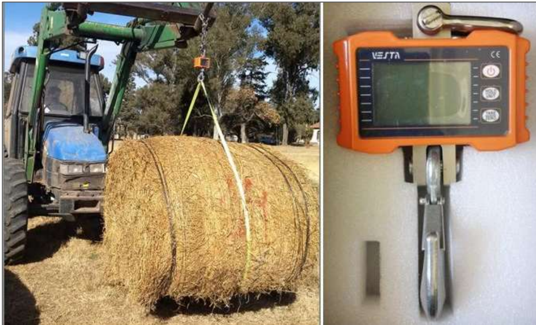
Figura 6: Medición de peso de cada repetición a partir del uso de balanza de gancho, Dinamómetro Crane Scale 3265-1, comercializada por la firma Vesta. Operación realizada para cada rollo al comienzo y al final del período de almacenamiento a campo.
