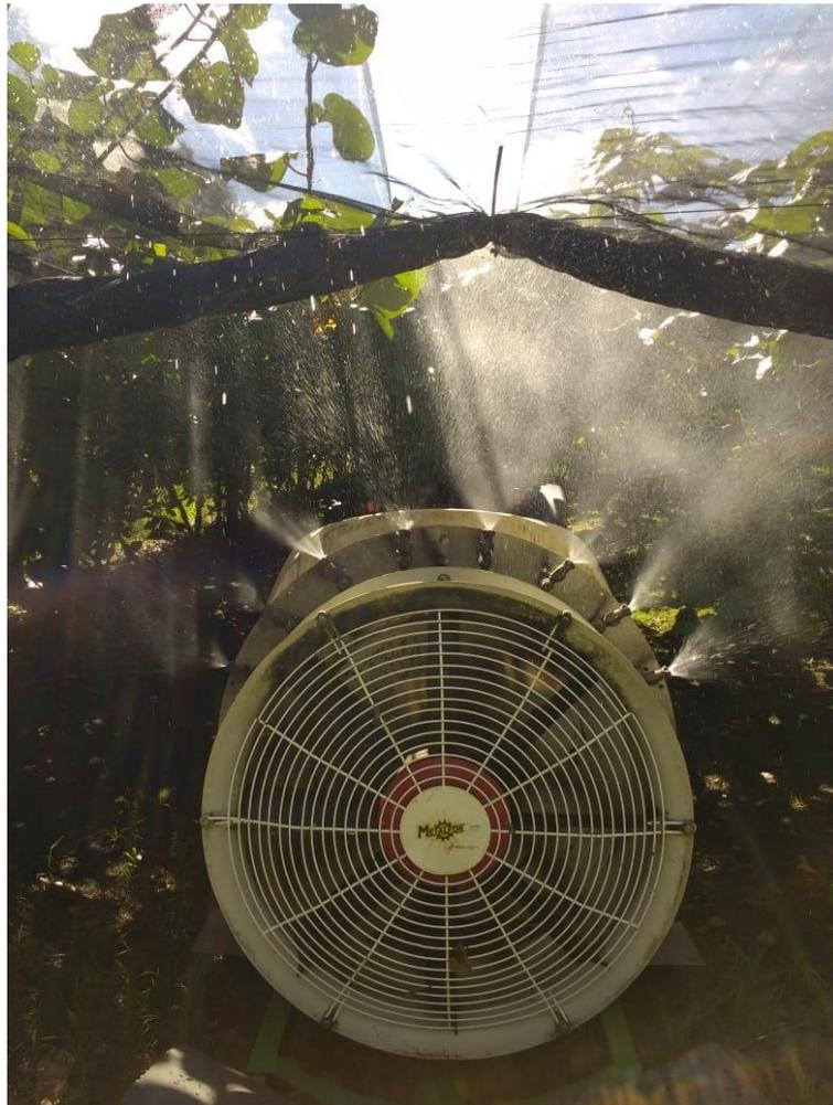
**Figura 8.** Equipo pulverizador asperjando KPhi a las plantas de kiwi.
