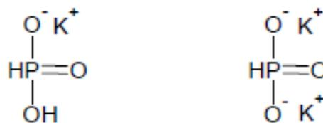
**Figura 4.** Estructura de la molécula del fosfonato hidrógeno de potasio (izq.) y del fosfonato de dipotasio (der.) (EFSA, 2012a)
