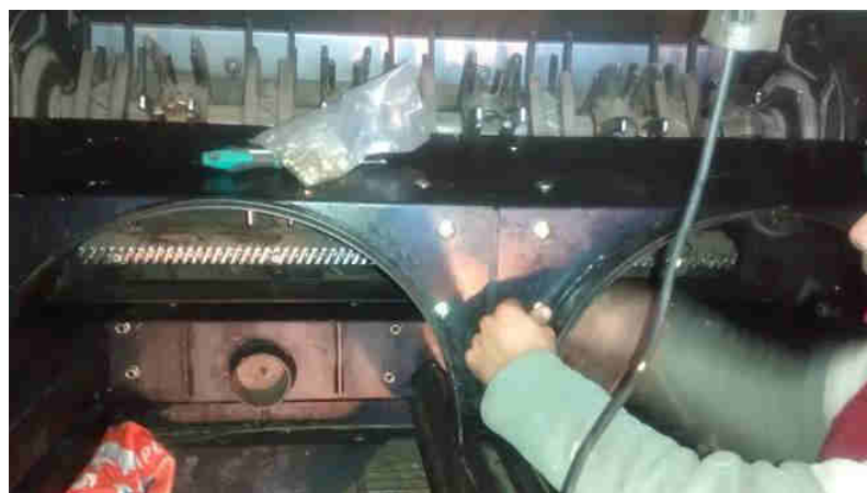
Figura 2. Vista trasera del rolo expulsador, reformado con dedos de fundición; el cual descarga los residuos de la trilla, sobre los rotores axiales.
