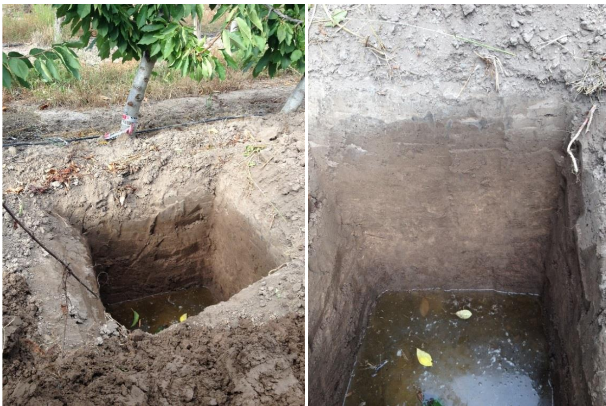
Figura 24. Calicata del sitio de estudio de La Deseada - Allen en la que se observa el perfil de humedecimiento y la posición de la tabla de agua.
