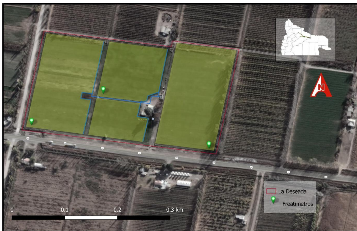
Figura 20. Plano de La Deseada - Allen. Los puntos verdes indican los freatímetros instaladas; las líneas azules indican los ramales principales del riego localizado en los cuadros con cerezos.
