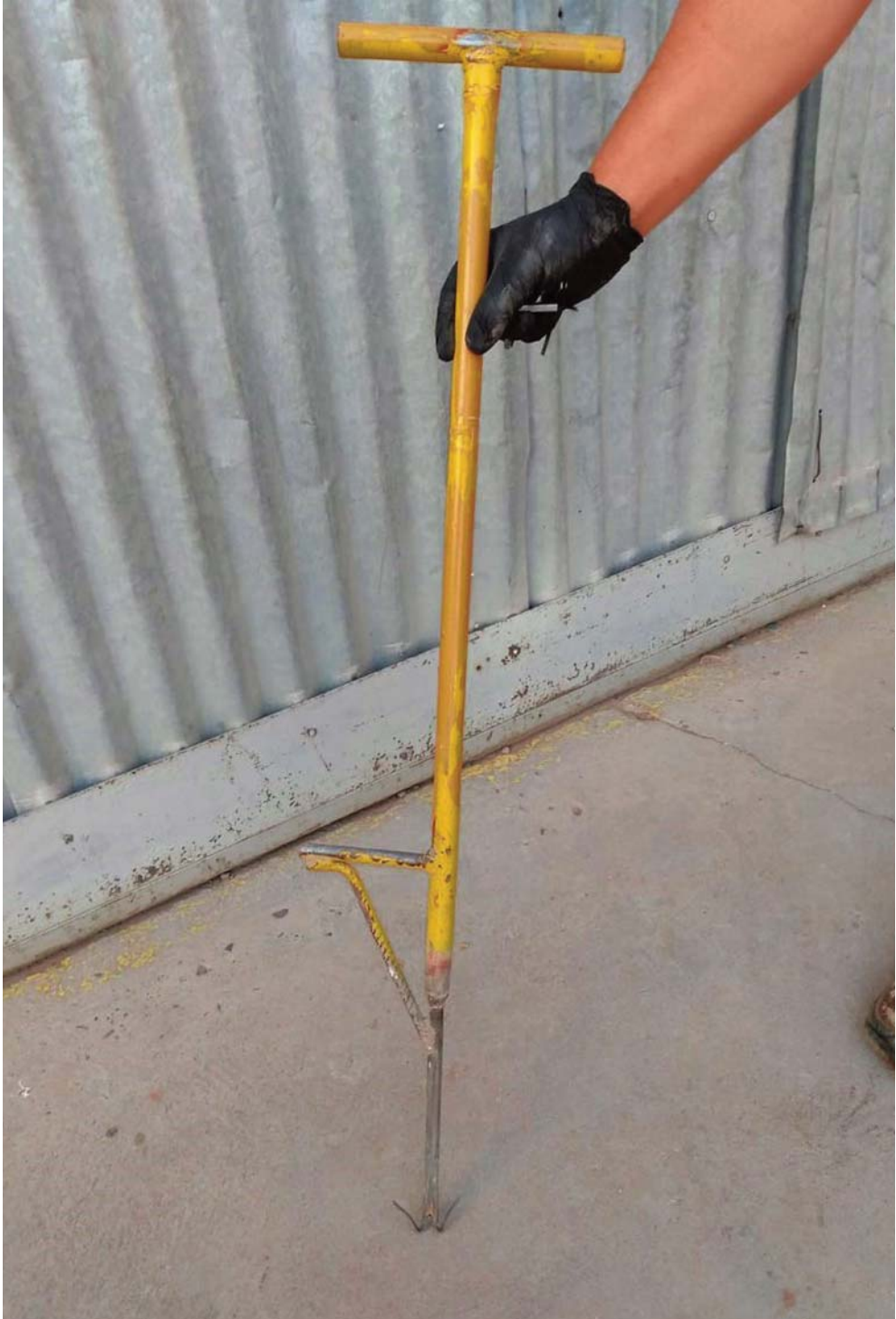
Foto 54. Barreta para insertar alambres "W" al suelo. Alto Valle del río Negro.
