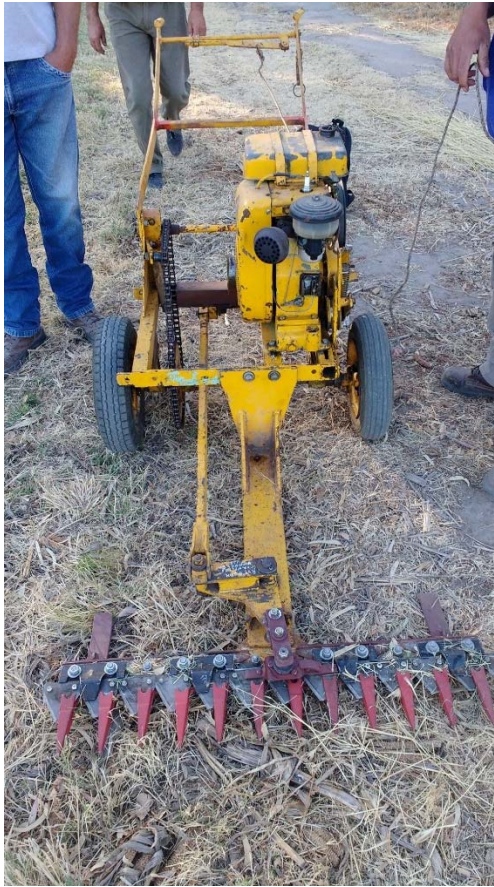
Imagen #2: Maquina segadora con motor Villa utilizada para el corte de las parcelas
