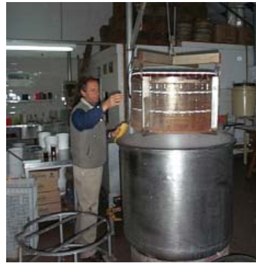
Figura 49: Pasteurizadores para pequeña escala. (a) Uso hogareño; (b) Uso comercial de varios (Gentileza Dulcería Flía. Mengoli. El Bolsón - Río Negro) o de uno solo canasto (Gentileza Establecimiento Masseurbe. El Hoyo - Chubut)
