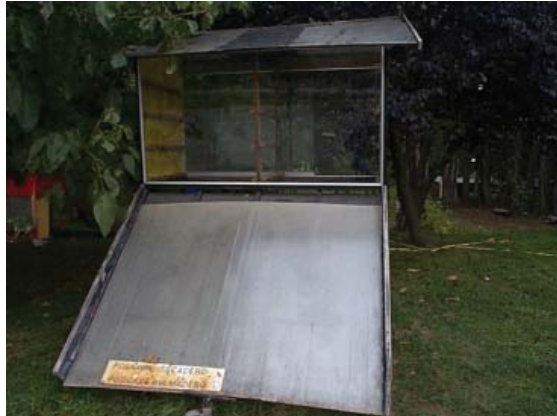
Figura 30: b.- Secadero con aprovechamiento de calor solar (Gentileza Cervecería El Bolsón - El Bolsón - Río Negro)
