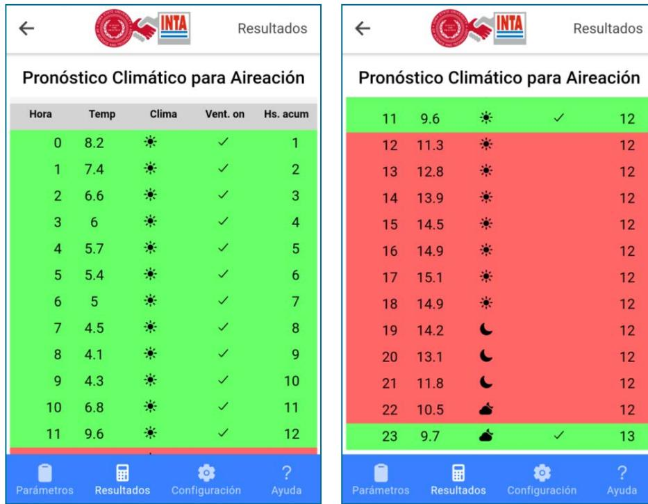
**Figura 8.** Captura de pantalla de la herramienta de Pronóstico Climático de Aireación donde se muestra la recomendación de encendido o apagado del ventilador en función de la temperatura límite prescrita (10°C) para cada hora. En el ejemplo, se recomienda mantener encendida la aireación hasta las 11 hs, apagarla y mantenerla apagada hasta las 23 hs, donde se debería volver a encender.
