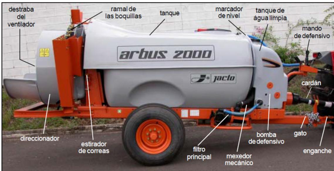
Figura 23. Pulverizadora Jacto Arbus 2000 (Fuente: Manual del equipo).
