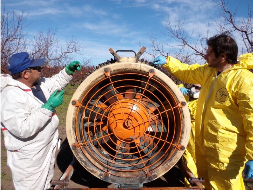
Figura 25. Cambio del emboquillado de la pulverizadora (Fuente: elaboración propia).
