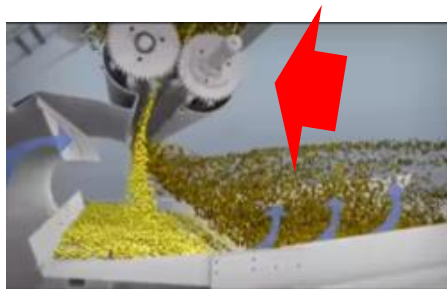
Figura 8. Vista de dibujos esquemáticos en 3D de rodillos dentados que generan una caída de los granos y granza en cascada (Butler AGCO, 2014).
