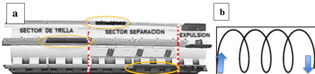
Figura 6. a) Vista del rotor de trilla-separación-expulsión, con su configuración original (las barras horizontales en negro ejemplifican la disposición de sus estrías en sentido contrario a la de giro). b) Esquema del sentido de giro y avance del material, durante el proceso mencionado.
