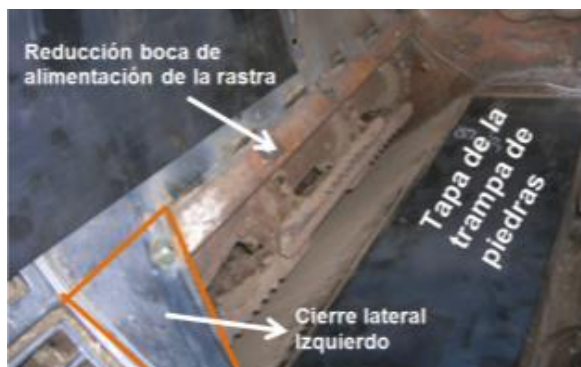
Figura 2. Vista interior del sector alimentación al rotor de trilla-separación, de la cosechadora Gleaner R66.
