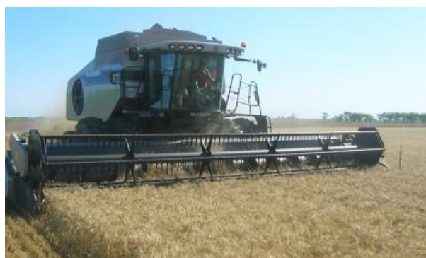
Figura 10. Cosechadora Gleaner R66, trabajando sobre el cultivo de trigo. Obsérvese la correcta regulación del molinete, sobre un cultivo bien erecto y de espigas uniformes.
