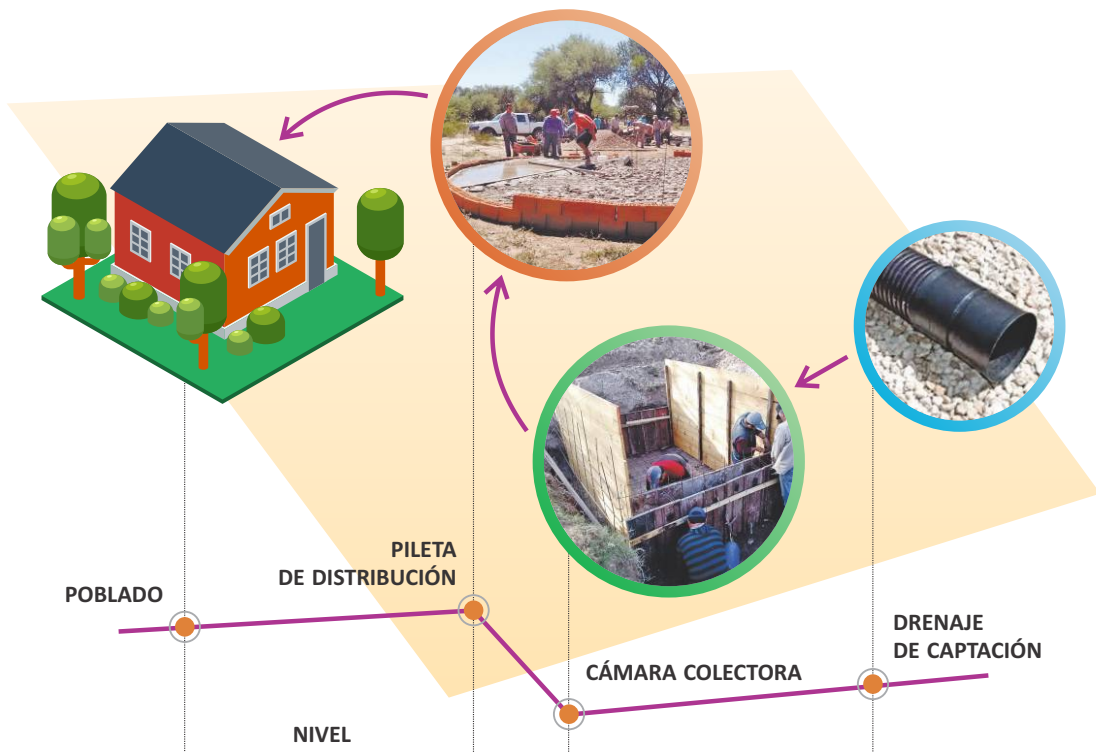
Figura 1. Sistema de captación y distribución de agua propuesto en la comunidad de El Consuelo.
