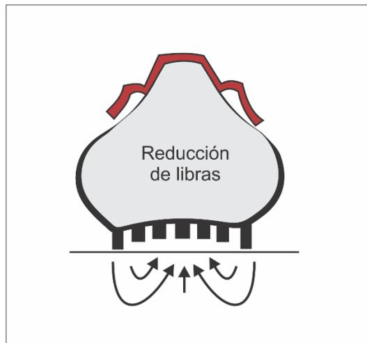
Figura 1. Reducción de libras de inflado de los neumáticos para aumentar la flotabilidad.
