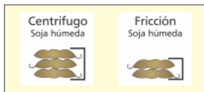
Referencia de luz de apertura entre rotor y camisa para soja húmeda.
