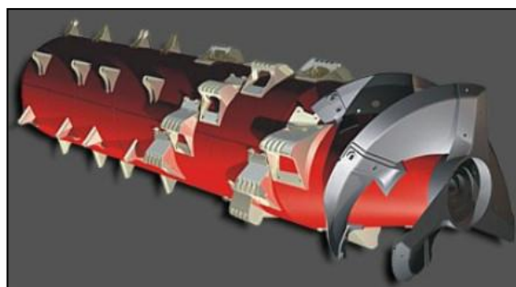
Figura 13. Rotor axial por fricción.
