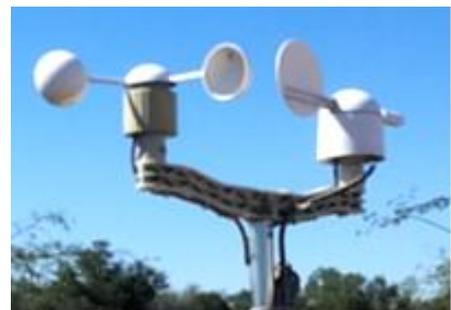
Figura 9. Anemómetro (izq.) y veleta (der.) automáticos.
