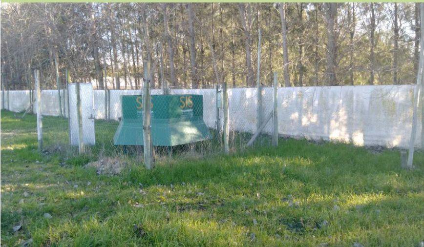
Figura 3. Sistema de movimiento de aire denominado sumidero invertido selectivo para el control de heladas.
