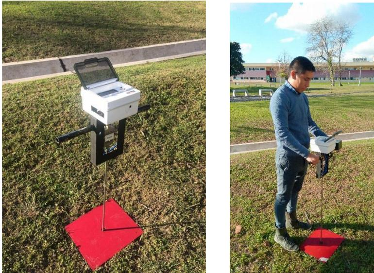
*Figura 1:* Medidor de compactación Edáfica “Penetrómetro Digital”.
