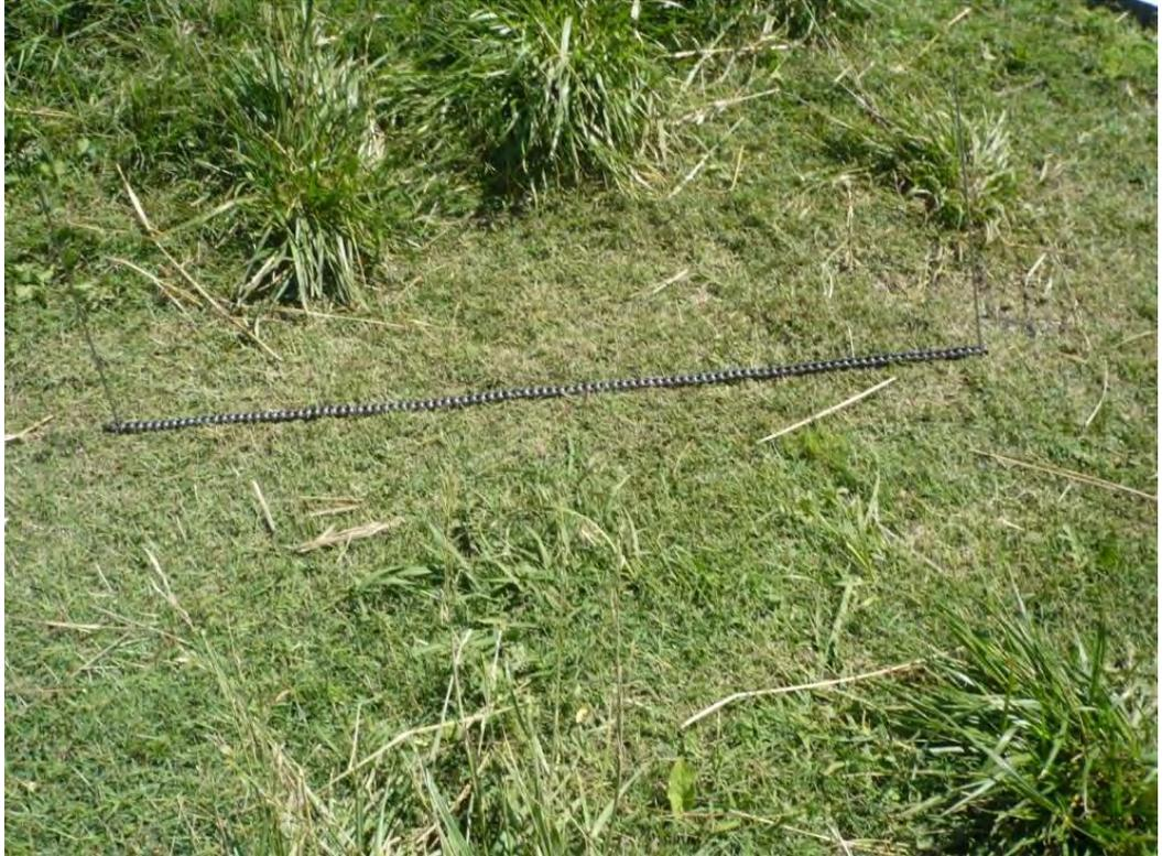
Figura 8. Mediciones de rugosidad del suelo utilizando el método de la cadena, en arroyo Del Azul.
