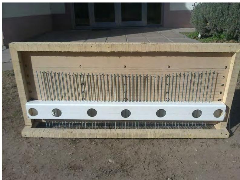
Figura 19. Bastidor de agujas verticales utilizado para medir el perfil de las vías de flujo preferenciales (Langhi, 2015).
