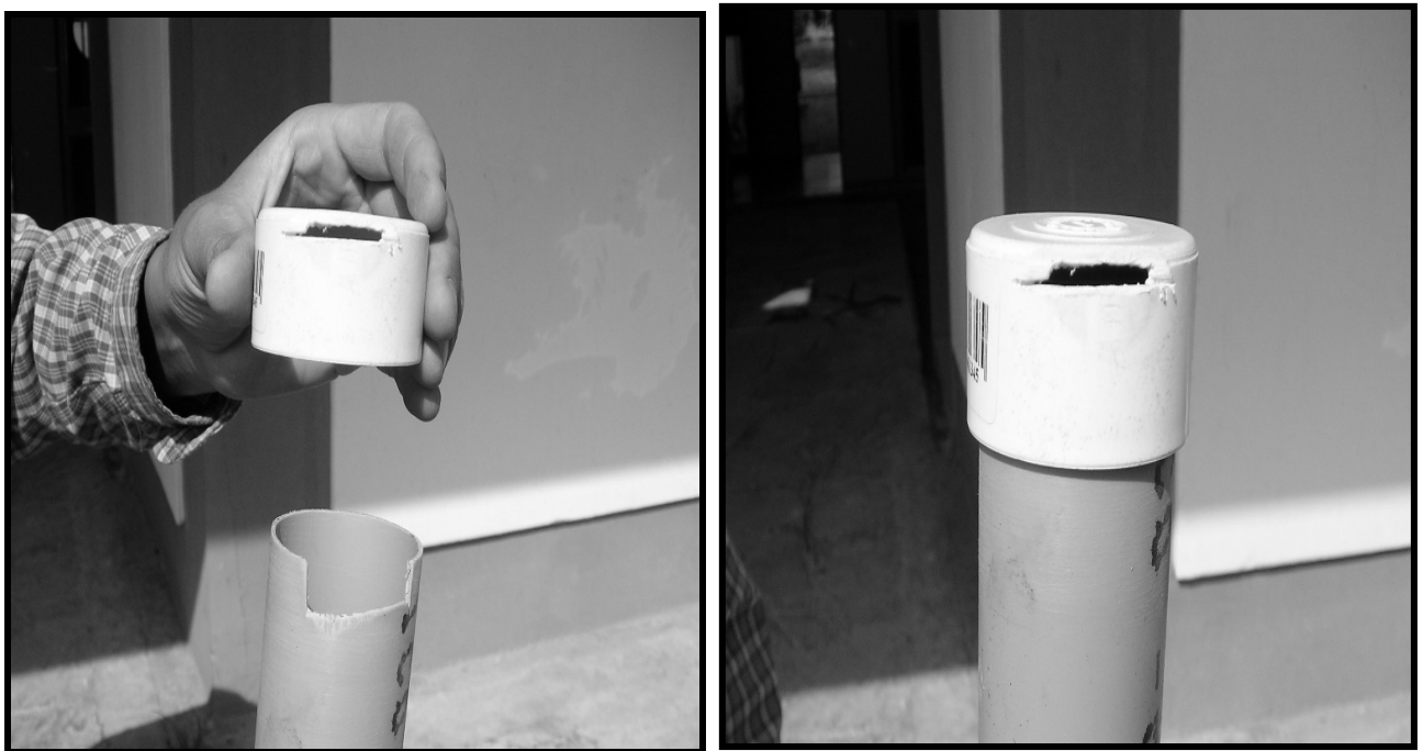
Fig 4. Tapa de protección con ranura para ingreso de cinta métrica
