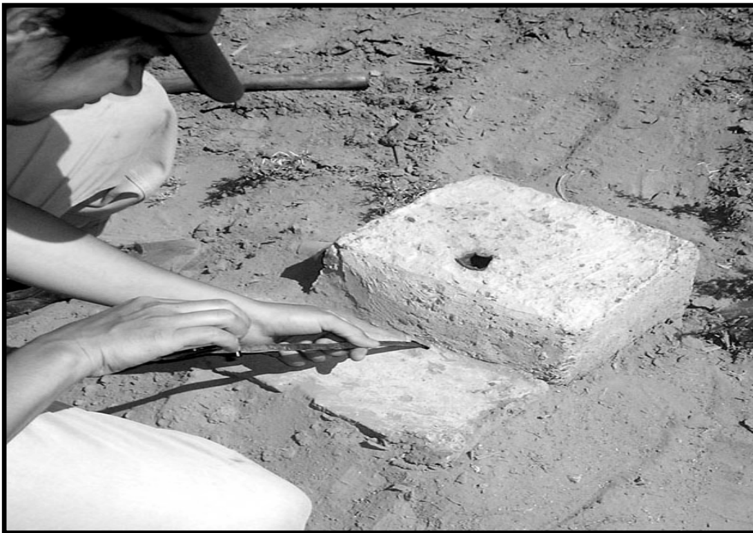
Fig. 7. Introducción de cinta métrica para lectura del freaímetro
