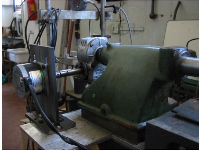
Figura 24: Motor eléctrico “paso a paso”, reductor y eje telescópico de movimiento horizontal encargado de dar el movimiento de traslación a la parte inferior de la caja de corte.
