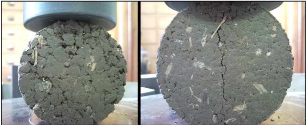
Figura 13: Cilindro colocado en la máquina (izquierda) y cilindro comprimido exhibiendo rotura (derecha).
