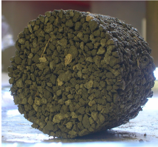
Figura 12: Cilindro listo para ser sometido a Brazilian Test .
