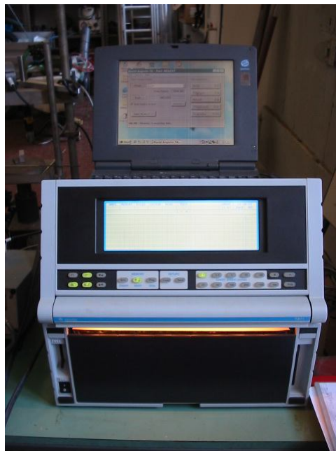
Figura 27: Colector de Datos Gould TA11 y ordenador portátil utilizados en la adquisición y almacenamiento de las señales.
