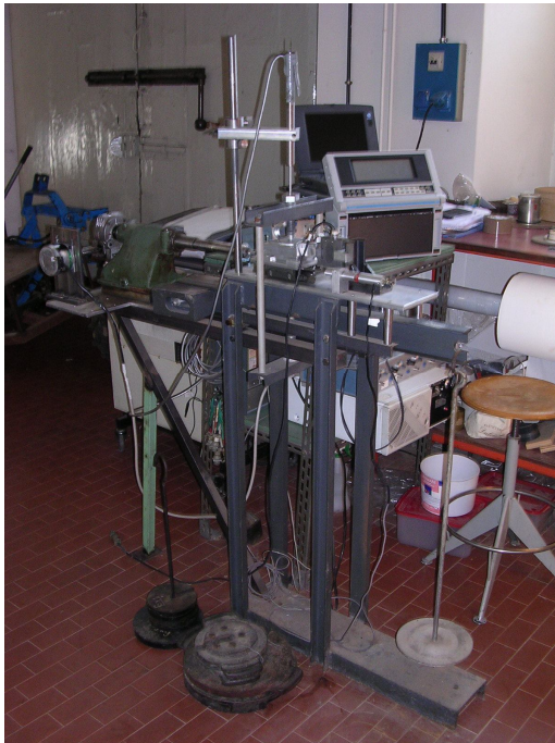
Figura 23: Vista general de la Caja de Corte Directo construida en el DIAF .
