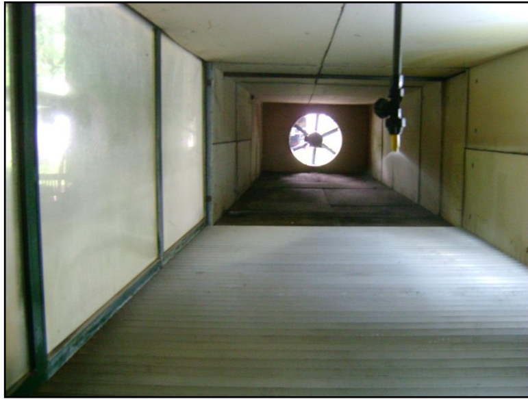
Figura: 2.2. Túnel de viento con boquilla ubicada en posición de trabajo.
