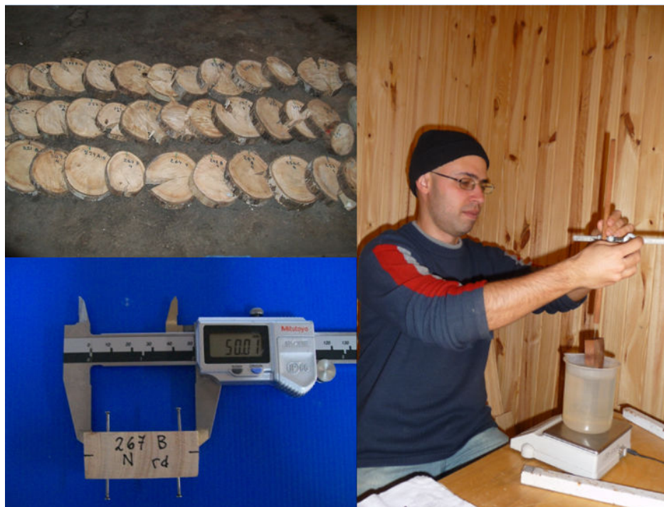
Figura A.4.5: Rodajas utilizadas para la confección de probetas y determinación de propiedades físicas
