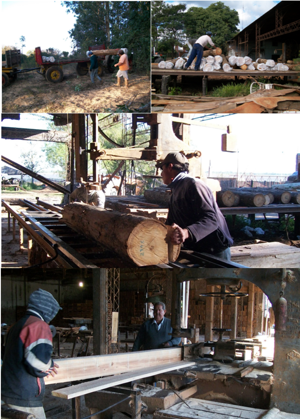
Figura A.4.3: operaciones de carga, descarga y aserrado de rollizos.
