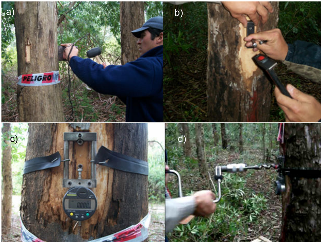
Figura 3.2: Pasos sucesivos en la determinación de los valores GSI con el método CIRAD-Forêt.
