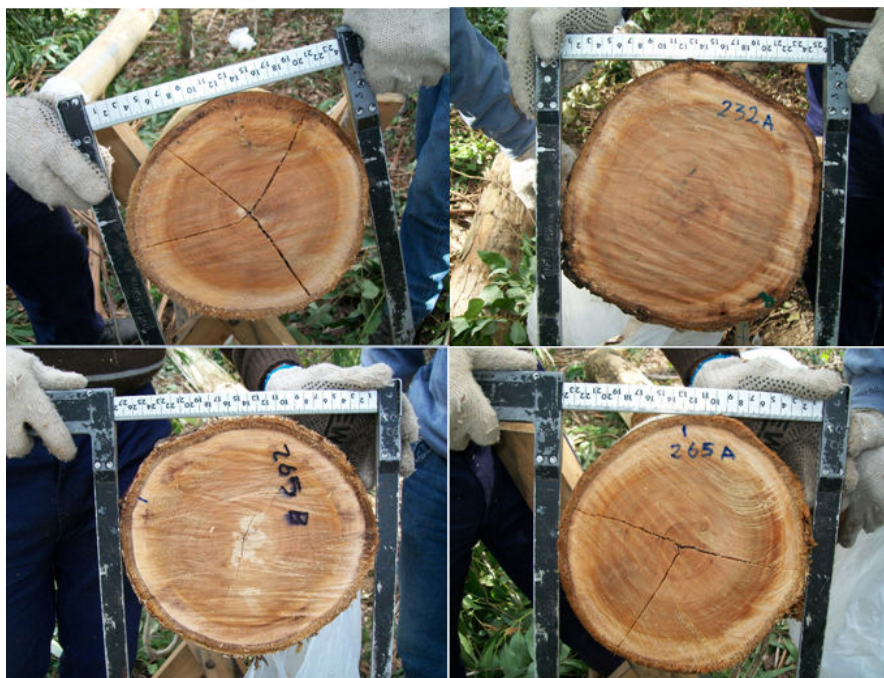
Figura A.4.2: Caras transversales de rollizos con diferente nivel de intensidad de estrellado.
