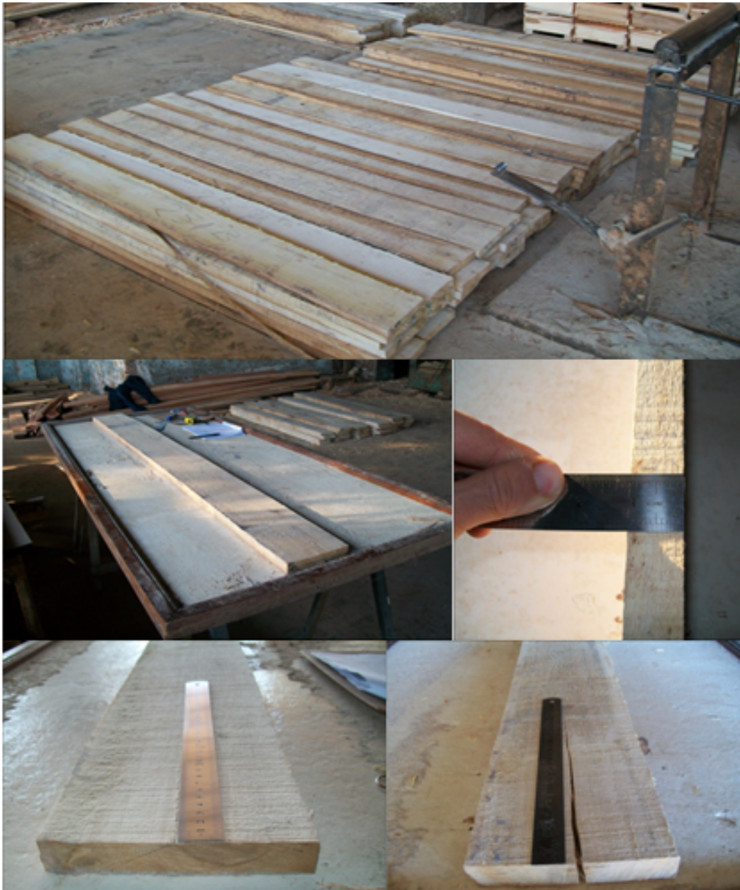
Figura A.4.4: Pasos realizados en la medición de dimensiones de tabla, número y largo de rajaduras de cabeza.
