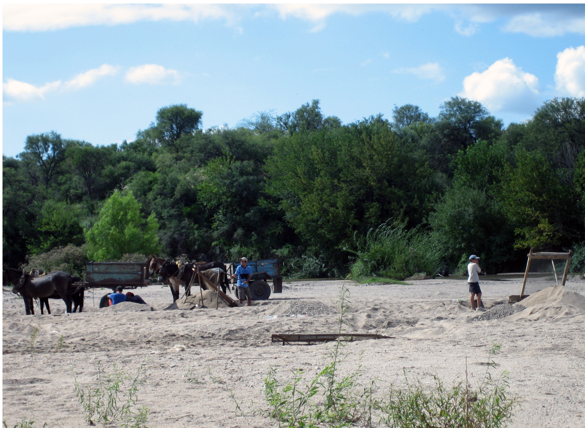
Fotografía N° 5. Extracción de arena del lecho del río
