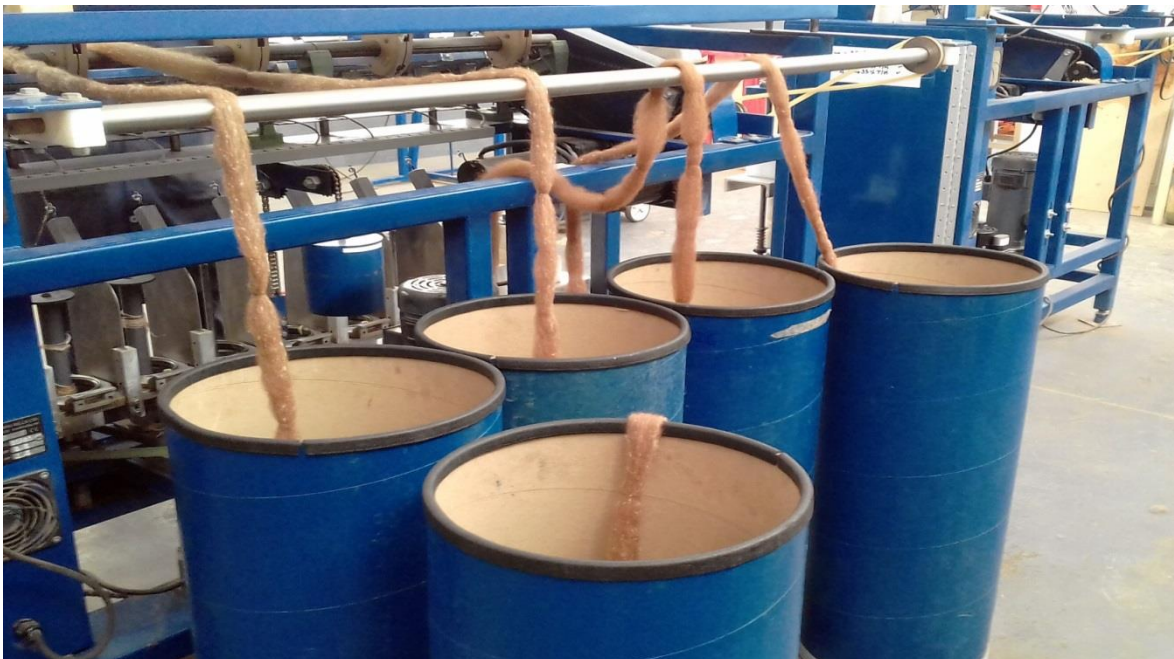
Fotografía 5: Tachos con rovings de llama (pura y mezcla con seda) alimentando la hiladora.
